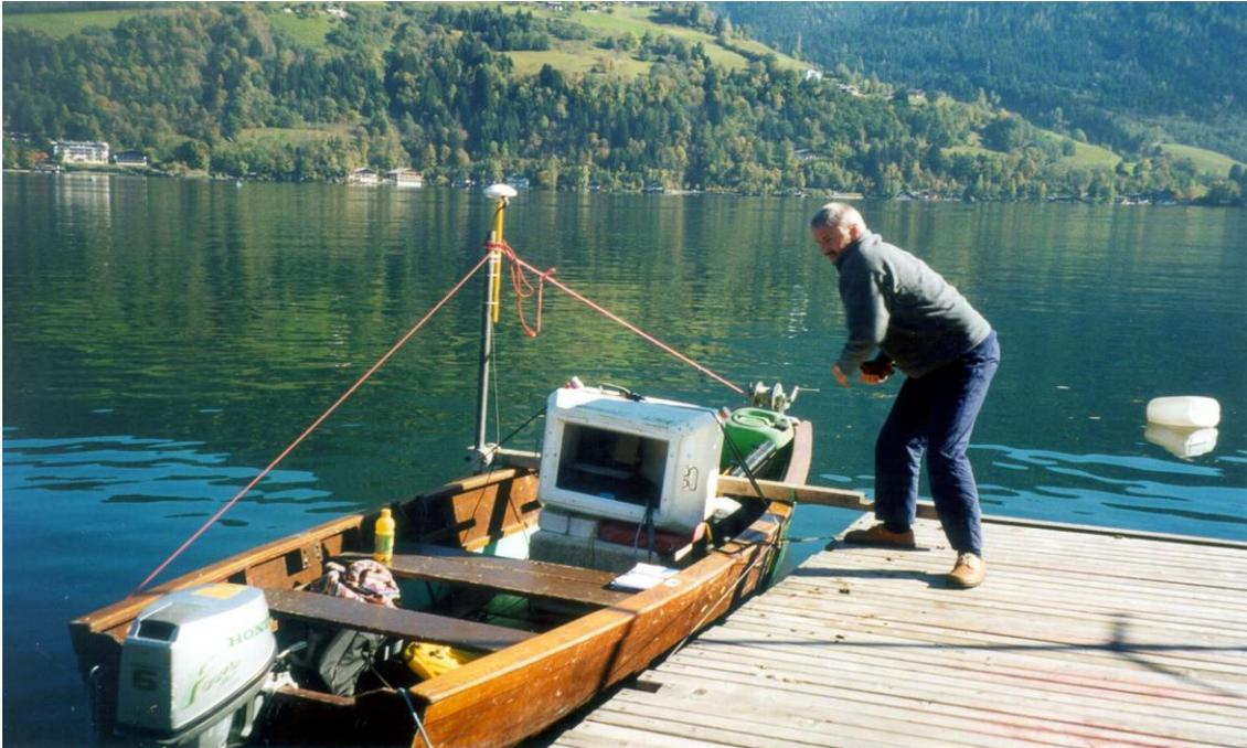
*Abbildung 3: Echolotboot mit montierten Transducer (Schallgeber und -empfänger)*
