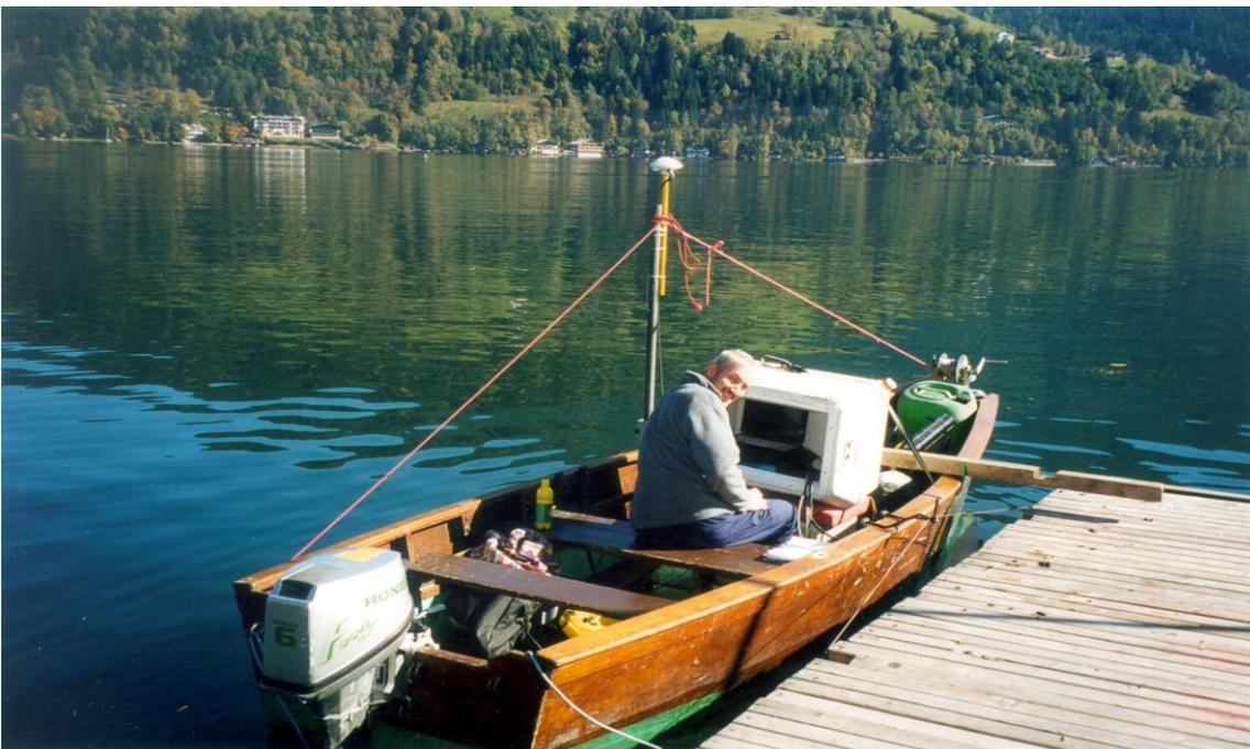
*Abbildung 4: Echolotboot mit montierten Transducer (Schallgeber und -empfänger)*
